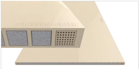
WPC strip & PU foam filling WPC 条和聚氨酯泡沫填充
