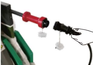
3. Conecte el cable de la placa calefactora a la placa calefactora. Está conectado correctamente solo cuando se emite el sonido "Click".
