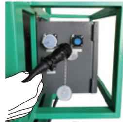
2. Conecte el cable de la unidad de potencia a la caja de distribución. Está conectado correctamente solo cuando se emite el sonido "Click".
