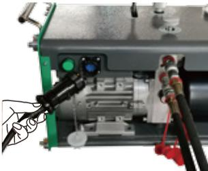
1. Conecte el cable de la unidad de potencia a la unidad de potencia. Está conectado correctamente solo cuando se emite el sonido "Click".
