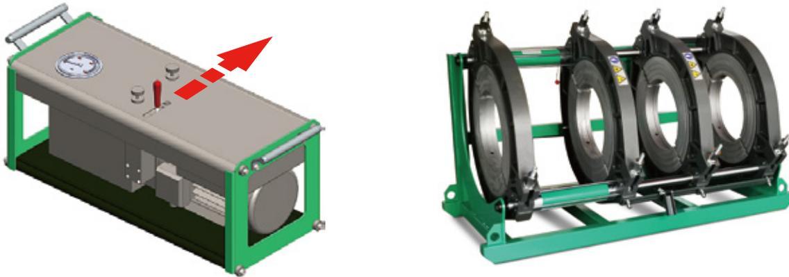
Gire gradualmente la válvula reguladora de presión en sentido horario hasta que el manómetro muestre la presión ( $P_1+P_t$ ).
