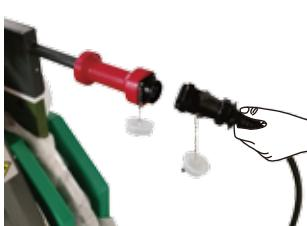
Conecte el cable de la placa calefactora a la placa calefactora. Está conectado correctamente solo cuando se emite el sonido "Click".
