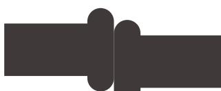
Desalineación. Soldadura bajo la condición de que la desalineación excede el 10% del grosor de la pared de la tubería mientras se alinean los dos extremos.
