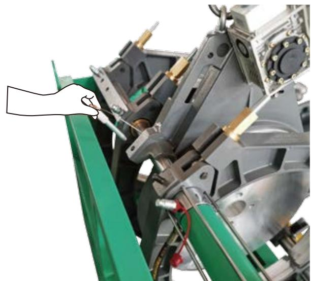
Mantenga el refrentador colocado en la barra del pistón superior con la ayuda de la perno de bloqueo.
