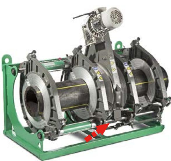
Apoye la recortadora sobre el vástago del pistón inferior.
