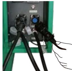
Conecte el cable del refrentador a la caja de distribución. Está conectado correctamente solo cuando se emite el sonido "Click".
