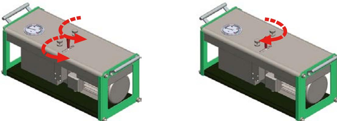
Luego empuje la palanca de dirección al máximo y gire gradualmente la válvula regulada por presión en el sentido de las agujas del reloj, hasta que el carro móvil se ponga en movimiento. Lea la presión actual en el medidor y escríbala.
