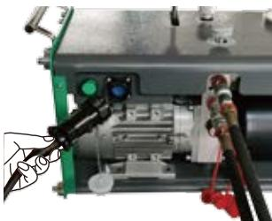
Conecte el cable de la unidad de potencia a la unidad de potencia. Está conectado correctamente solo cuando se emite el sonido "Click".
