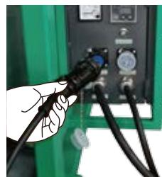
Conecte el cable de la unidad de potencia a la caja de distribución. Está conectado correctamente solo cuando se emite el sonido "Click".
