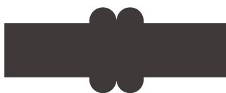
A una zanja en la articulación. No se alcanzó la temperatura o el tiempo de cambio fue demasiado largo antes de soldar.
