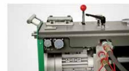
Todos las conexiones están situadas en la parte posterior de la central hidráulica
