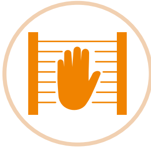
手掌保护 间距20mm Palm protective spacing
