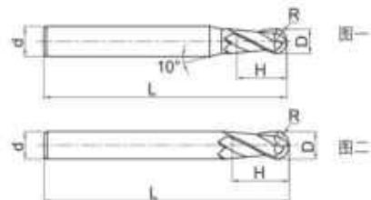
● 适用于仿形铣削。 ● 最适于高速切削、干式切削。
