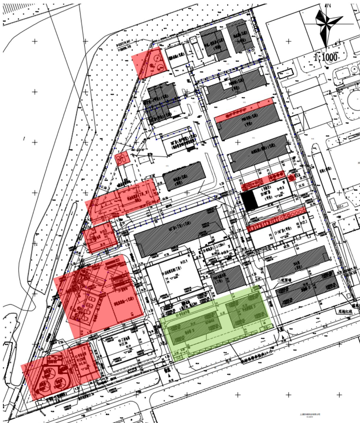
图 7.3-1 分区防渗图（红色区域属重点防渗区、绿色区域属简单防渗区、未标注部分属一般防渗区）
