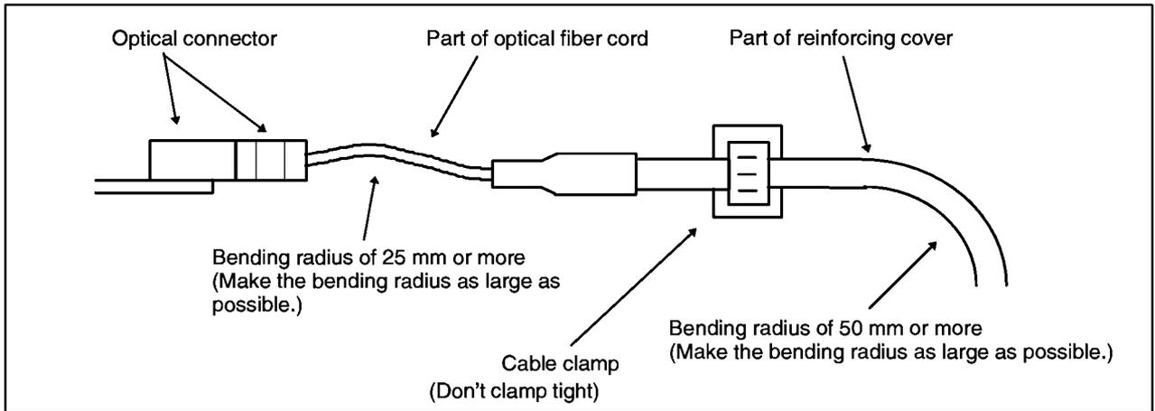
**Fig.D (d) Fixing the cable with a clamp**
