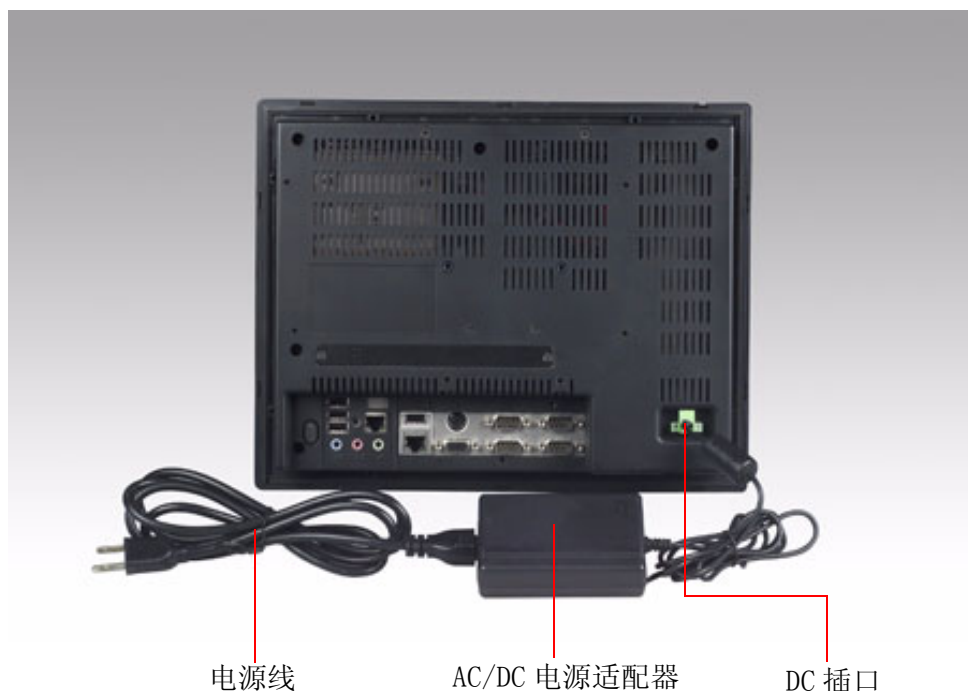
图 2.5: 连接电源线与 DC 插口
