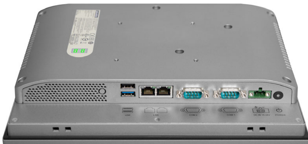
图 1.4： PPC-3100S-PBE 底部接口
