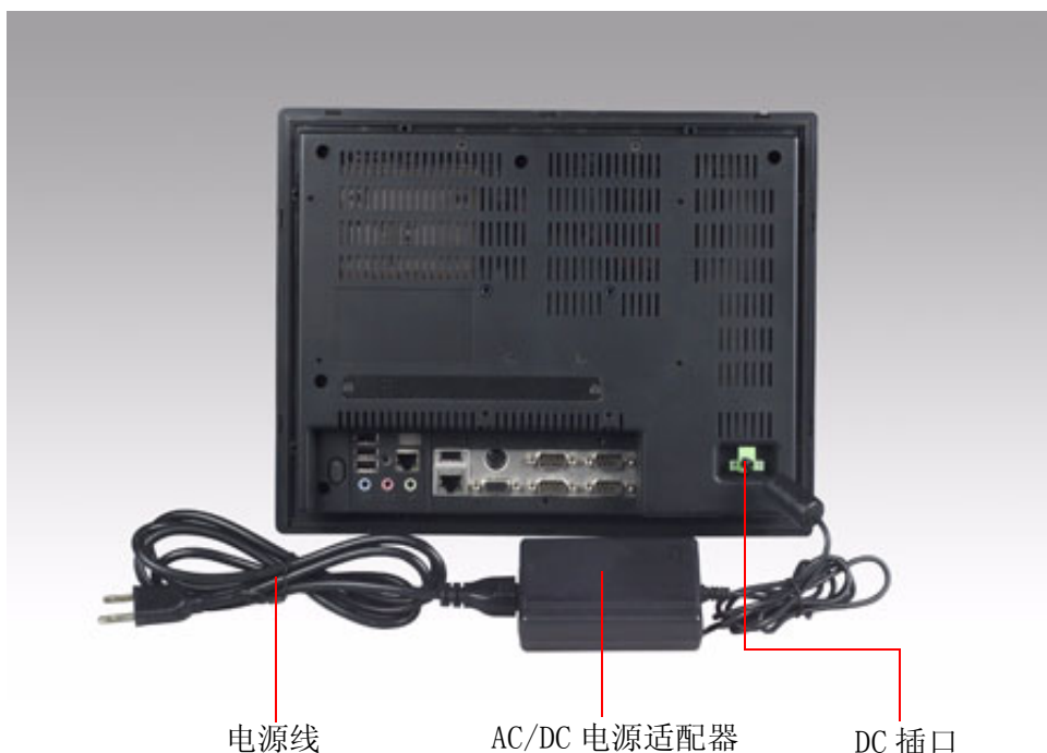
图 2.5: 连接电源线与 DC 插口
