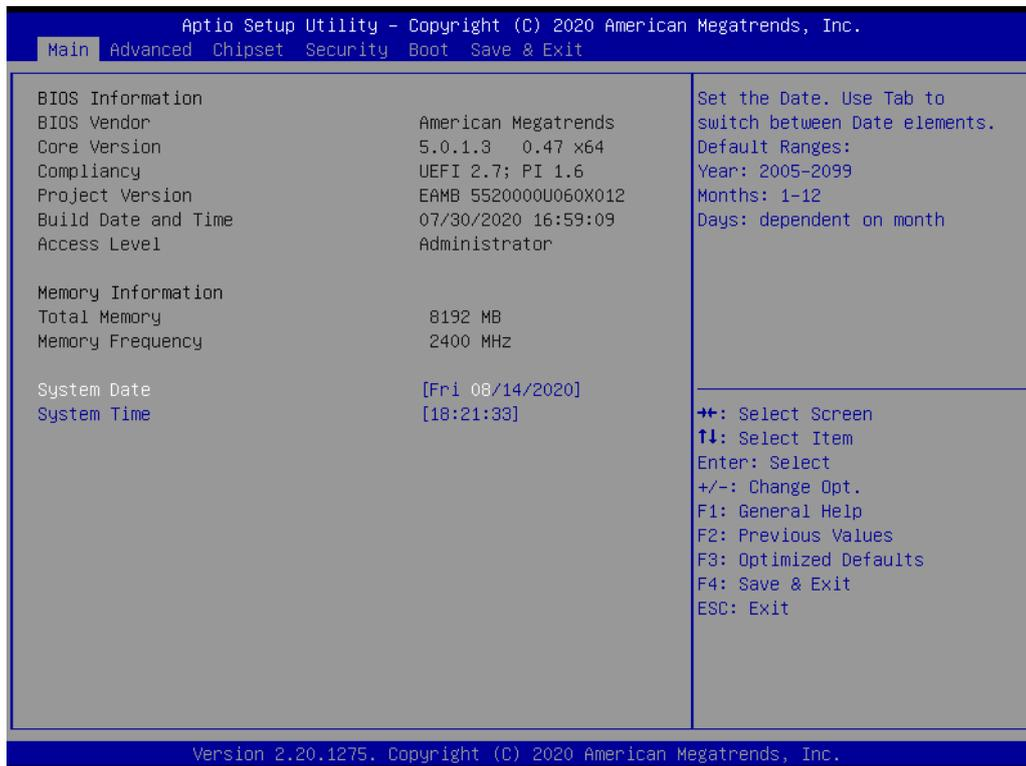
BIOS 设置主菜单由 2 部分构成。左栏显示的是可以配置的所有项。灰色的为不可配置的项，蓝色的则相反。右边栏为箭头图例。
