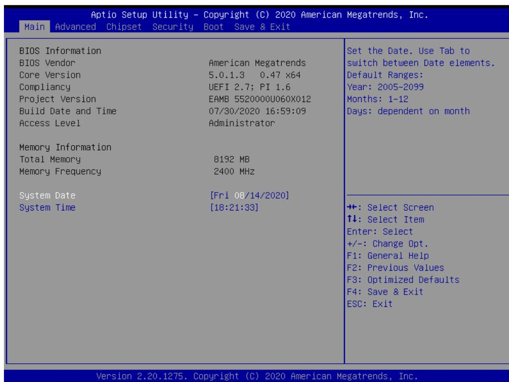
BIOS ROM 带有内置的设置程序，允许用户修改基本系统配置信息。这些信息保存在由电池供电的 CMOS 中，因此在电源关闭时仍不会丢失。
