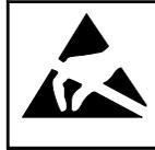
EGBs können durch Spannungen und Energien zerstört werden, die weit unterhalb der Wahrnehmungsgrenze des Menschen liegen. Solche Spannungen treten bereits dann auf, wenn ein Bauelement oder eine Baugruppe von einem nicht elektrostatisch entladenen Menschen berührt wird. Bauelemente, die solchen Überspannungen ausgesetzt wurden, können in den meisten Fällen nicht sofort als fehlerhaft erkannt werden, da sich erst nach längerer Betriebszeit ein Fehlverhalten einstellen kann.
