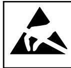
CSCEs pueden quedar afectados incluso por tensiones y energías situadas por debajo de la facultad perceptiva del hombre. Estas tensiones aparecen cuando una tarjeta o un módulo son tocados por un ser humano que no se ha descargado electrostáticamente. Los componentes que han sido sometidos a estas sobretensiones no pueden ser reconocidos inmediatamente como averiados en la mayoría de los casos, ya que se puede producir un fallo después de mucho tiempo de estar en uso.
