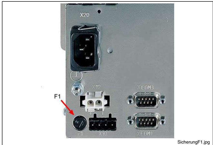
Fig. 8-7: Fuse F1 on the connector panel
