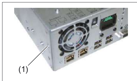
Figure 19-14 PCU 50.3 equipotential connection
