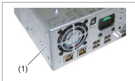
Figure 19-14 PCU 50.3 equipotential connection
