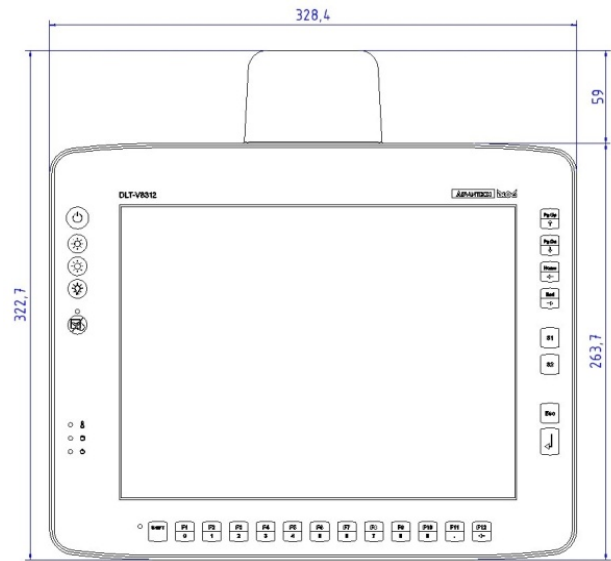
DLT-V8312 (mit 5 oder 26 Front-Tasten erhältlich)
