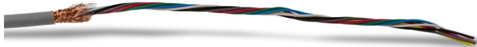
Figura 2-25: Cabo da Célula de Carga com a Blindagem Externa Removida, Fio Blindado Cortado
