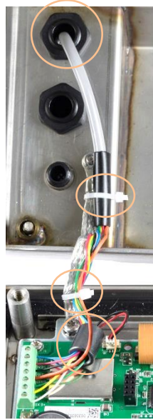
Abbildung 2-24: Stifferung der analogen Wägezelle und Ferritperleninstallation, IND236
