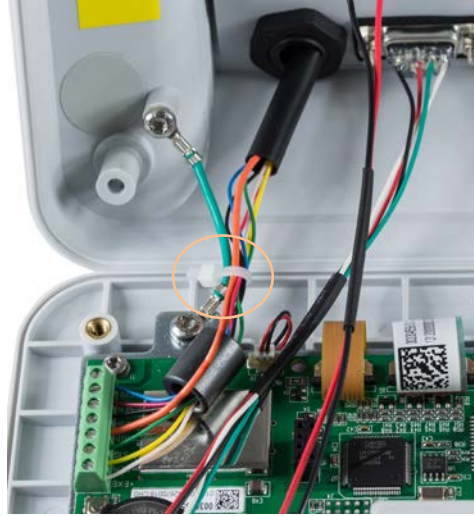
Figura 2-20: Instalação de Ferrite e Pino Terra da Célula de Carga Analógica, IND231
