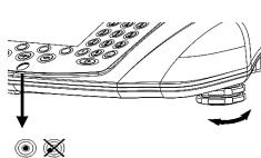
Die Waage wie folgt nivellieren:
