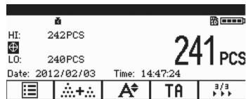
Si le résultat de pesée de contrôle est conforme aux exigences spécifiées de plage de pesée de contrôle, la ligne de valeur cible  $\oplus$  est mise en surbrillance, indiquant que le résultat actuel est conforme aux exigences de plage de pesée de contrôle.
