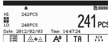
Si el resultado del control de peso cumple con el requisito del rango de control de peso especificado, la línea de valor final  $\oplus$  aparecerá realizada, indicando que el resultado actual cumple con el requisito del rango de control de peso.
