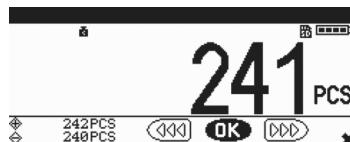
En mode majuscule, la ligne de touches de fonction disparaît automatiquement si on n'appuie sur aucune touche pendant 2 secondes.
