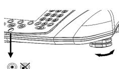
1. Girar los pies de nivelación de la balanza, hasta que la burbuja de aire del nivel de burbuja esté dentro del círculo interior (ver ilustración).
