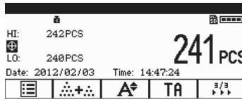
Wenn das Kontrollwägeergebnis der spezifizierten Bereichsanforderung für das Kontrollwäge entspricht, wird die Zielwertzeile  $\oplus$  hervorgehoben, um anzudeuten, dass das aktuelle Ergebnis der Bereichsanforderung für das Kontrollwäge entspricht.
