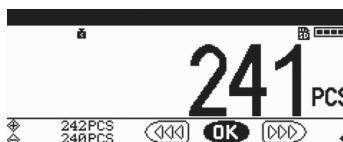
Im Modus Große Schrift wird die Zeile der Funktionstasten ausgeblendet, wenn 2 Sekunden lang keine Taste gedrückt wird. Stattdessen wird die Statusinformation des Kontrollwägens angezeigt. Nach dem Drücken einer Funktionstaste wird die Kontrollwäge-Statusinformation wieder durch die Zeile der Funktionstasten ersetzt.
