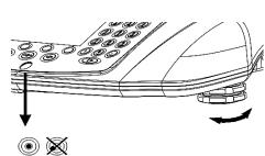
1. Tournez les pieds de mise à niveau de la balance jusqu'à ce que la bulle d'air du niveau à bulle d'air soit positionnée dans le cercle intérieur (voir image).
