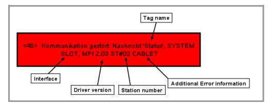
Fig. 78 SIMATIC S7 - Fault messages
