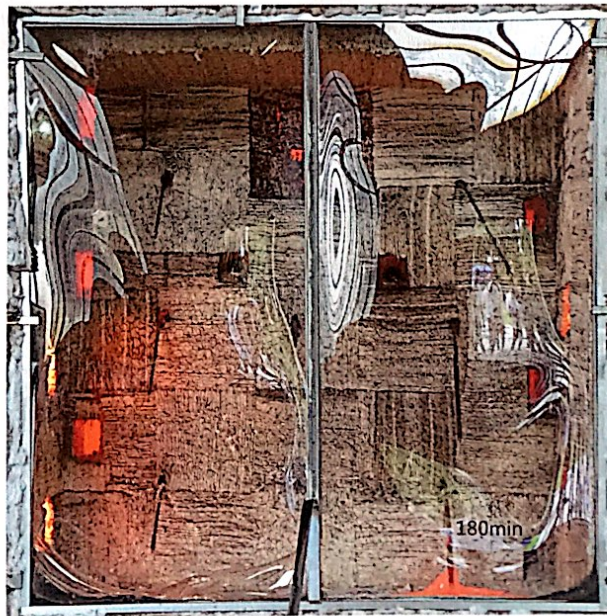
照片 2 耐火性能试验结束时试件情况
