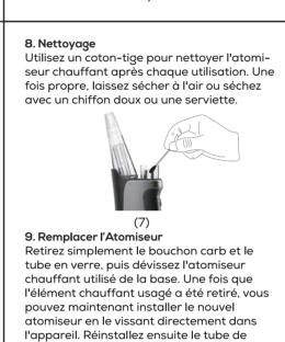
verre et le bouchon de carburateur. Vous devrez peut-être appuyer un peu sur l'atomiseur lors de l'installation de la nouve-Ile bobine, car l'atomiseur utilise un filetage à ressort.
