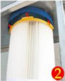
2. Mantenga el cartucho con las dos manos, para que seis orjas del filtro a soltar r ápidamente cubren seis brecha correspondiente.
