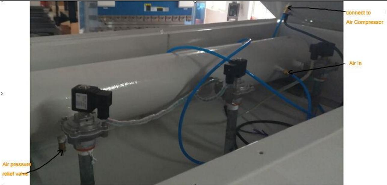
Connect to Air compressor : Conectado con aire compresor
